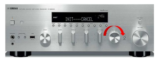
4. Schalten Sie ihren Receiver mit der "POWER ON / OFF" Taste wieder aus. Der Receiver wird jetzt in die Werkseinstellungen zurückgesetzt.
