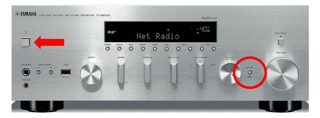
3. Bitte drehen Sie das Multifunktionsrad "SELECT / Enter" im Uhrzeigersinn, bis im Geräte Display "INIT.....CANCEL angezeigt wird.
