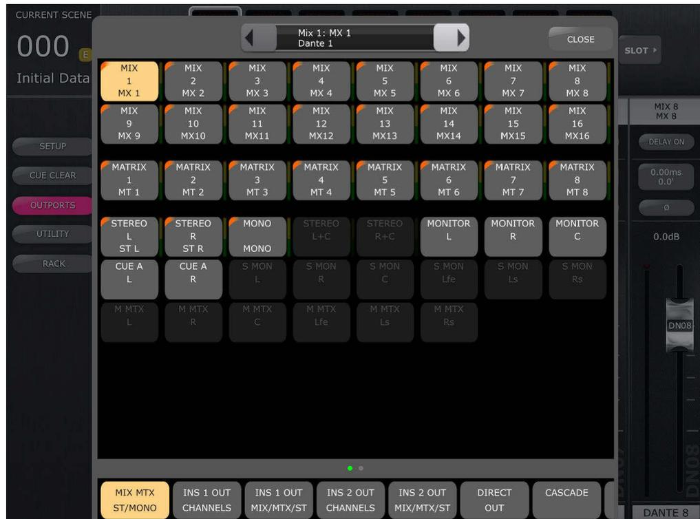
Wenn aktuell eine Zuordnung vorhanden ist, wird diese in der Zuordnungsansicht im Raster der Zuordnungstasten angezeigt und in der obersten Reihe des kleinen Fensters oben in der Mitte der Zuordnungsansicht. Die Zeile darunter zeigt den gewählten Ausgangs-Port an.
