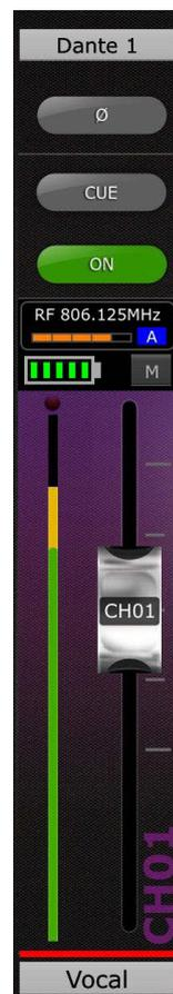
Oberhalb der Batterie- und Stummanzeigen befindet sich die Messanzeige für die RF-Intensität und die Anzeige für Diversity A/B.
