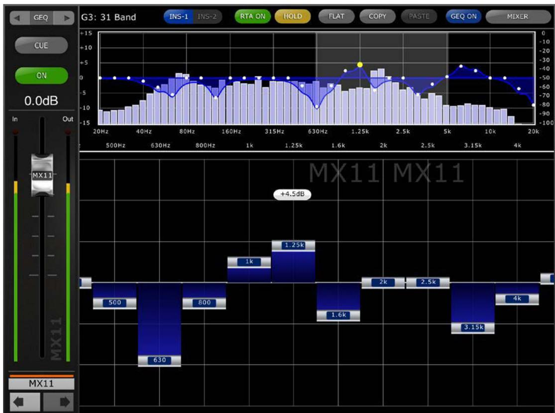
Name, Farbe, Schieberegler, Pegelanzeigen, [ON]- und [CUE]-Tasten des Kanals werden in der linken Spalte angezeigt. Unten links finden Sie Pfeiltasten, mit denen Sie den jeweils vorigen und nächsten Kanal erreichen können. Mit diesen Tasten erreichen Sie nur diejenigen anderen Kanäle, denen GEQs zugewiesen wurden.
