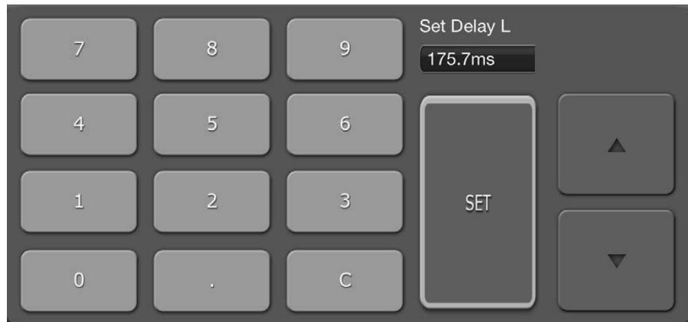
Tippen Sie auf die Taste, um das numerische Tastenfeld zu öffnen. Tippen Sie auf die Nach-oben-/Nach-unten-Cursorstasten, um den Parameterwert um jeweils einen Schritt anzupassen. Bei jedem Tippen der Cursorstaste wird der Wert an das Pult gesendet.
