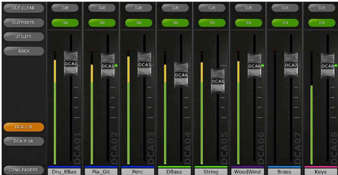
Drücken Sie erneut die Taste [DCA 1–8] bzw. [DCA 9–16], um die Bank der DCA-Schieberegler zu verlassen und zur zuvor ausgewählten Bank zurückzukehren. Alternativ können Sie in der Navigation/Meter Bridge eine beliebige Bank drücken, um direkt auf diese Schieberegler-Bank zuzugreifen.
