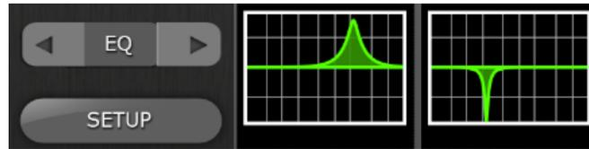
Mit den Tasten links der Miniaturansicht können Sie durch Antippen der linken und rechten Cursortasten zwischen EQ, PAN, 5.1 und Dynamik-Modus umschalten.
