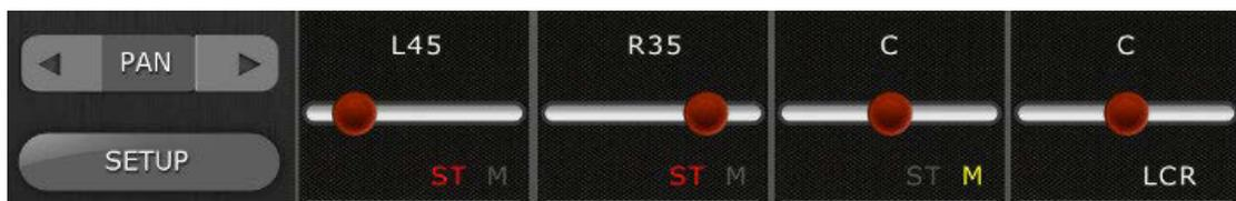
Durch Text wird angezeigt, ob die einzelnen Kanäle den ST-, Mono- oder LCR-Bussen zugewiesen sind.
