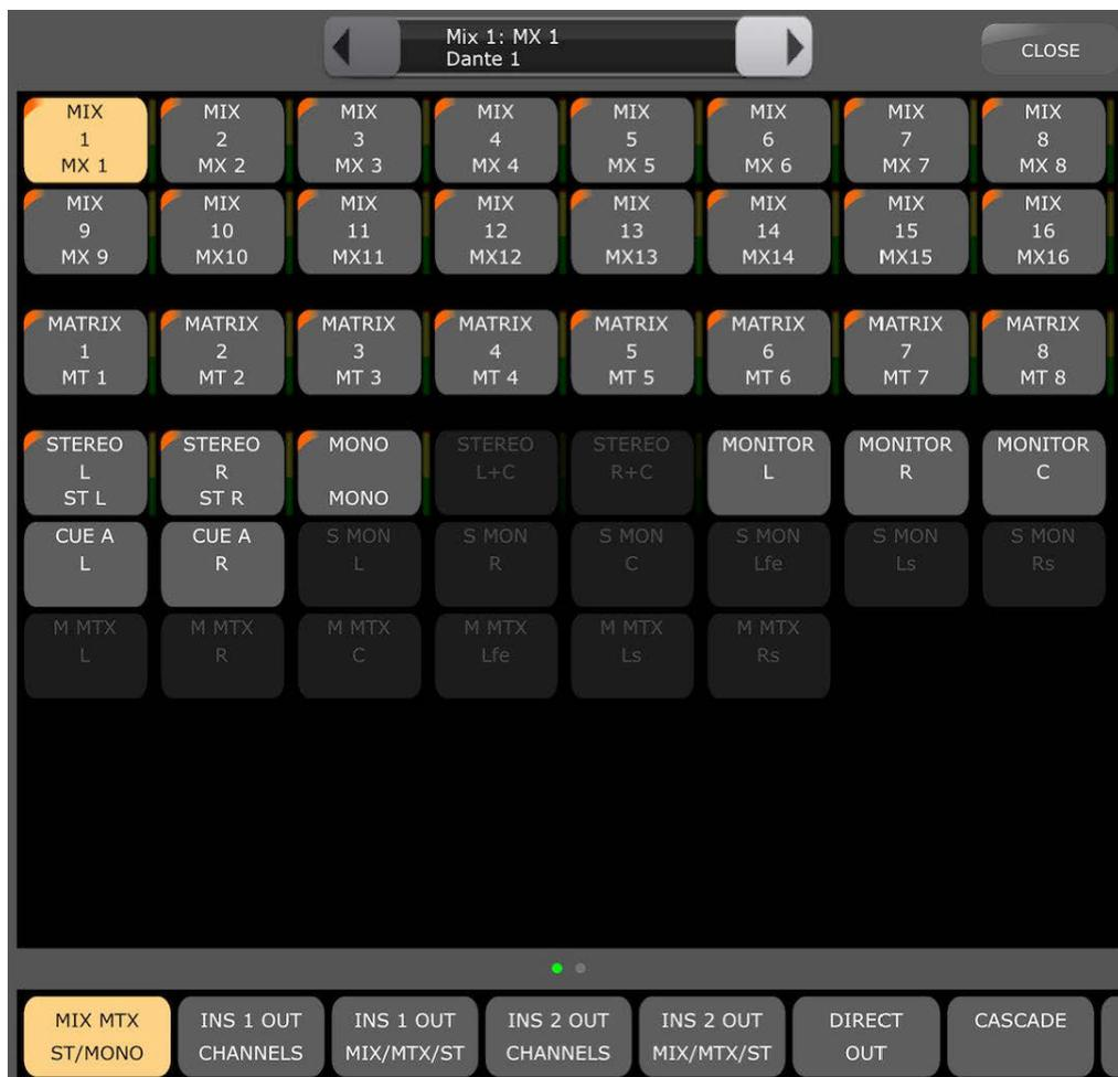
Auf jeder Schaltfläche des Rasters werden Nummer, Namen und Typ der Ausgangskanäle dargestellt. Wenn dem Kanal ein Name zugewiesen wurde, wird dieser auch mit der Kanalfarbe dargestellt, falls gewählt. Bei Mix/MT/Mono/ST-Ausgangsbus-Gruppen wird der Ausgangspegel links von jeder Schaltfläche dargestellt.
