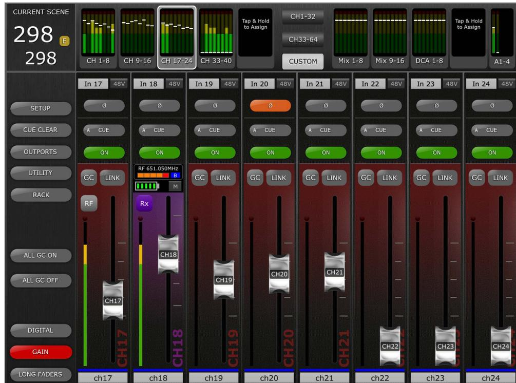
Tippen Sie auf diese Taste, um den HA-Kanalzug auf dessen Anzeige für RF-Steuerung und Überwachung umzuschalten. Der Kanalzug ändert seine Farbe zu Violett, um anzuzeigen, dass er nun einen RF-Kanal anzeigt, und auf der Taste oberhalb der Pegelanzeige erscheint RX, um anzuzeigen, dass der HA-Fader nun die RX-Verstärkung steuert.
