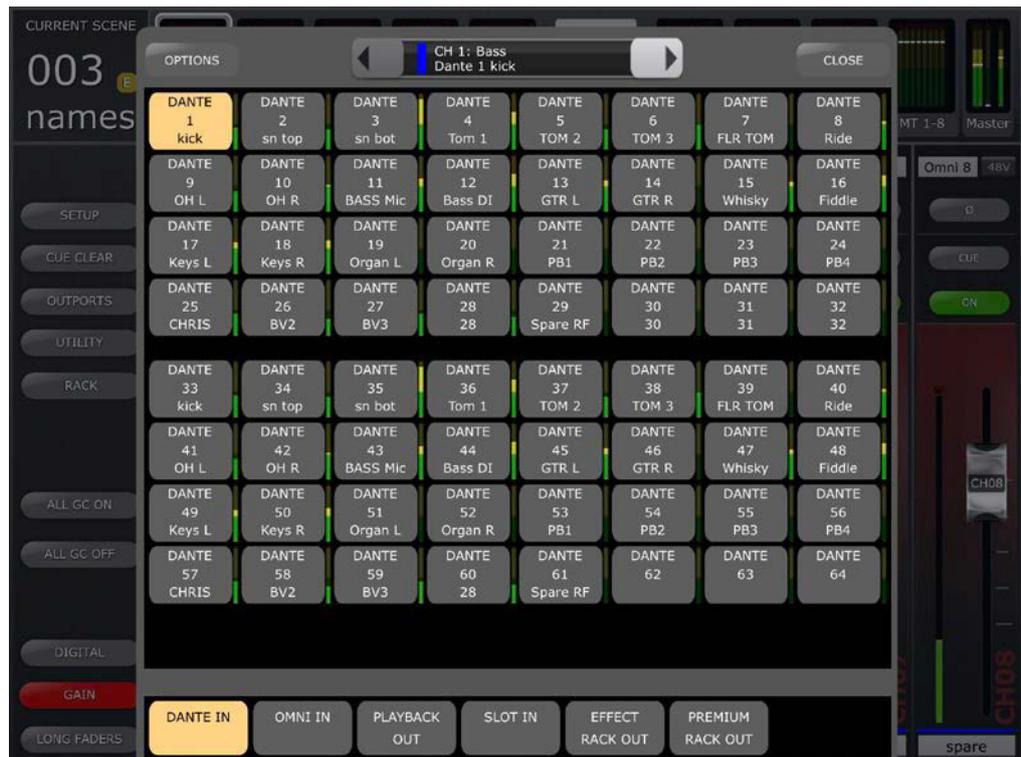
Nummer und Name des ausgewählten Kanals werden in der obersten Zeile oben im Display angezeigt. Darunter ist der aktuell ausgewählte Eingangs-Port dargestellt.
