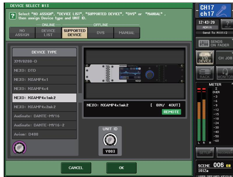
Die Anzeige ( **REMOTE** ) erscheint im Gerät mit Remote-Unterstützung.
