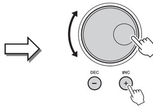
Drehen Sie am Datenrad oder drücken Sie die [DEC]/[INC]-Tasten, um den Eintrag zu laden bzw. auszuwählen. Ob der Eintrag geladen oder nur ausgewählt wird, hängt von der Einstellung in der Anzeige ab, die über [MENU] → [Utility] → [Touch Screen/Display] aufgerufen wird. Näheres erfahren Sie im Abschnitt „Utility“ im Referenzhandbuch auf der Website.
