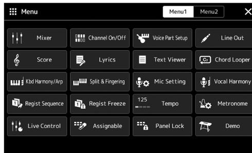
Verschiedene praktische Funktionen werden als Symbole angezeigt. Durch Antippen eines dieser Symbole wird die entsprechende Funktion aufgerufen. Diese Liste besteht aus zwei Seiten, die Sie auswählen können, indem Sie [Menu 1] oder [Menu 2] antippen, oder indem Sie die [MENU]-Taste mehrmals drücken.
