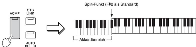
Gleichzeitig kann der speziell für die linke Hand festgelegte Bereich der Tastatur als Akkordbereich verwendet werden, und die in diesem Bereich gespielte Akkorde werden automatisch erkannt und als Basis für eine vollautomatische Begleitung mit dem gewählten Style verwendet.
