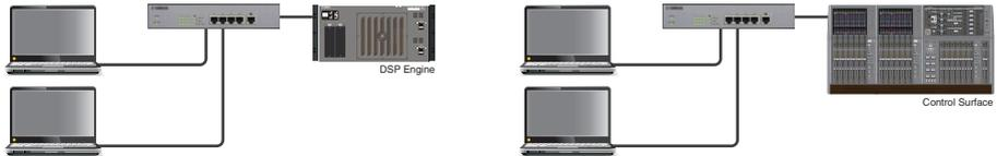
Wenn Sie zwei Computer an einer DSP Engine oder Bedienungsfläche anschließen möchten, verwenden Sie einen Switching Hub, um Verbindungen herzustellen.
