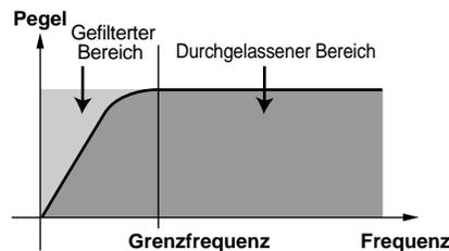
Ein "HPF" (Hochpaßfilter) ist das Gegenstück zu den obigen Filtern: hier werden nur die Frequenzen oberhalb der Grenzfrequenz durchgelassen (siehe "Cutoff Freq").
