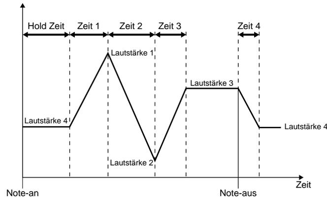
Je größer ein Time-Wert, desto länger dauert der Übergang zum Level-Wert. Der Wert "0" bedeutet, daß der Level-Wert mit derselben Nummer augenblicklich angefahren wird. Der Wert "99" hingegen vertritt die langsamste Übergangsgeschwindigkeit.
