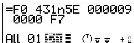
Solange die MIDI-Adresse eines Parameters angezeigt wird, können Sie mit VALUE [−] und [+] die Werte ändern und mit CURSOR [◀] und [▶] andere Parameter anwählen.
