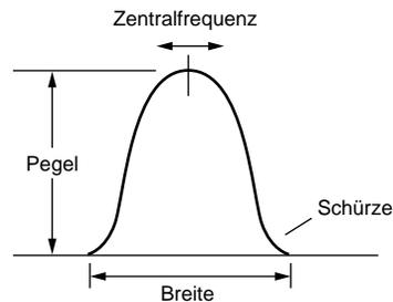
Nehmen wir zum Beispiel eine Formantkonfiguration, die einen "a"-Laut erzeugt. Daraus kann man ein "i" machen, indem man die Zentralfrequenz und den Pegel der Formanten verschiebt. Wenn man das in Echtzeit -und relativ schnell- tut, entsteht daraus der Laut "ai".
