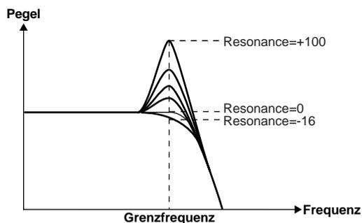
Je größer der hier eingestellte Wert, desto lauter werden die Frequenzen um den Cutoff-Wert und desto geringer wird die Bandbreite des Filters.
