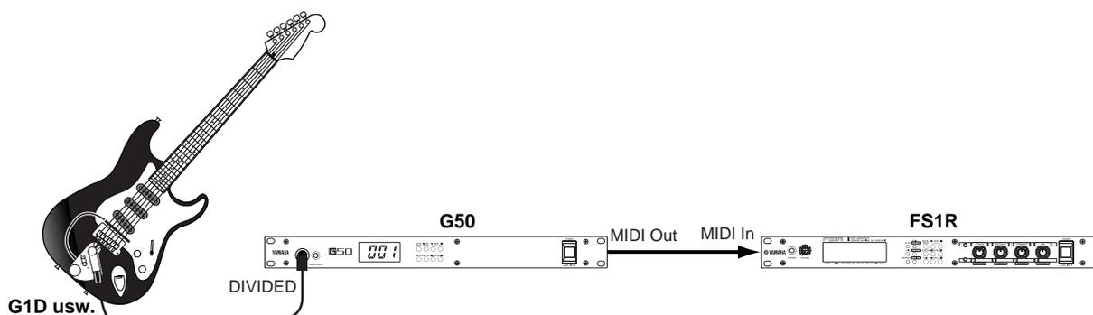
Da der G50 MIDI-Daten sendet, gelten auch hier die normalen Anschlußregeln wie bei Verwendung eines Tasteninstrumentes oder anderen MIDI-Controllers. Einer der Gründe, weshalb sich der FS1R auch für den G50 eignet, ist, daß jeder Performance-Part auf mehreren MIDI-Kanälen gleichzeitig empfangen kann (S. 23).
