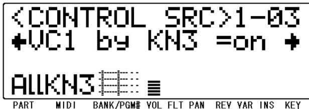
Wenn Sie "VC6 by FC" aktivieren ("on"), ist der Fußschweller Set 6 ("VC6") zugeordnet und kann also den mit "CtrlDst" gewählten Parameter und die hierfür aktivierten Parts beeinflussen.
