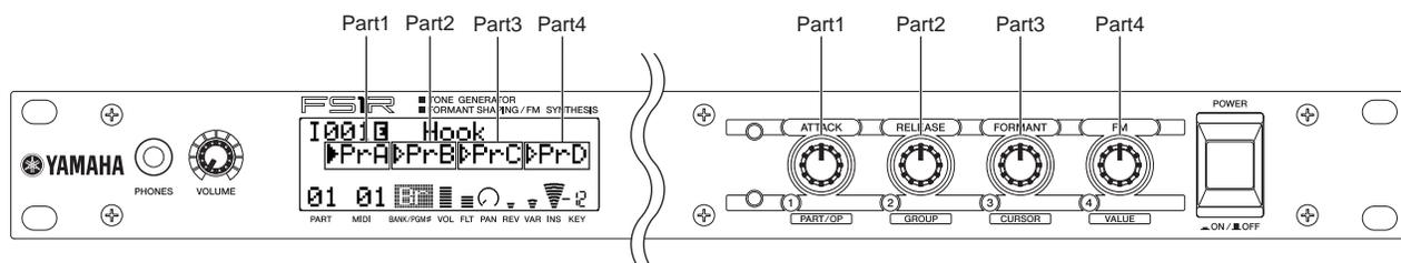
Wie dem auch sei, der zu editierende Part (01~04) kann mit PART [⊖] und [⊕] gewählt werden. (Die Nummer des gewählten Parts wird links unten im Display angezeigt.) Die Parameter können mit CURSOR [◀] und [▶] aufgerufen werden. Der Name des jeweils gewählten Parameters erscheint rechts oben im Display, und das dunkle Dreieck zeigt an, welcher Parameter gerade gewählt ist. Nach Anwahl eines Parameters können Sie seinen Wert mit VALUE [⊖] und [⊕] wunschgemäß einstellen.
