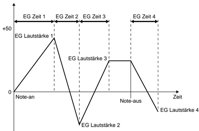
Je größer ein Time-Wert, desto länger dauert der Übergang zum Level-Wert. Der Wert "0" bedeutet, daß der Level-Wert derselben Nummer augenblicklich angefahren wird. Der Wert "99" hingegen vertritt die langsamste Übergangsgeschwindigkeit.
