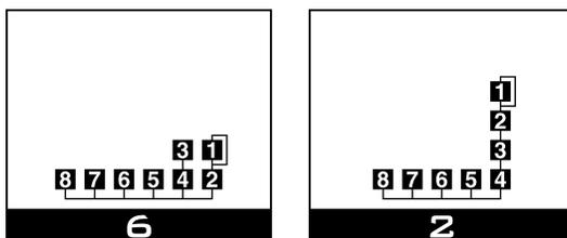
In den drei eben erwähnten Algorithmen enthält Operator 1 außerdem eine Rückkopplungsschleife (Feedback), die ein Teil des ausgegebenen Signals noch einmal an Operator 1 anlegt, wodurch sich noch komplexere Klangfarben ergeben. Alle Operatoren verfügen über eine eigene Amplitudenhüllkurve, so daß man auch hier getrost von nahezu unbegrenzten Klangmöglichkeiten sprechen kann.
