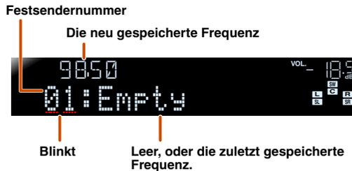
Drücken Sie **4** PRESET ^ / v, um die Festsendernummer zu wählen, unter der Sender gespeichert werden soll, und drücken Sie dann **4** MEMORY, um den Speichervorgang durchzuführen.
