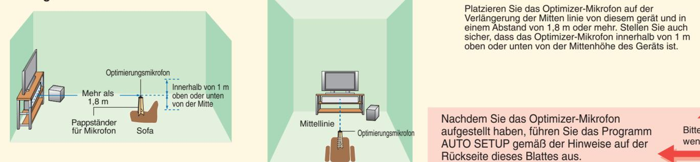
Nachdem Sie das Optimizer-Mikrofon aufgestellt haben, führen Sie das Programm AUTO SETUP gemäß der Hinweise auf der Rückseite dieses Blattes aus.
