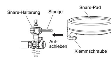
3. Lösen Sie die Klemmschrauben A bis D, wie unten gezeigt, um die Höhe und den Winkel der Spielfläche des Snare-Pads einzustellen. Sobald die richtige Position gefunden ist, ziehen Sie die Schrauben wieder gut fest, bevor Sie mit dem nächsten Schritt fortfahren.
