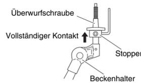
6. Stecken Sie eines der in Schritt 2 entfernten Filzpolster auf den Beckenhalter.
