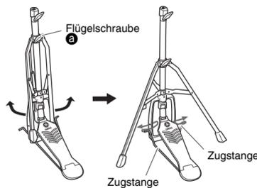
5. Lösen Sie wie rechts gezeigt die Flügelschraube b, um die Hi-Hat-Kupplung zu entfernen.
