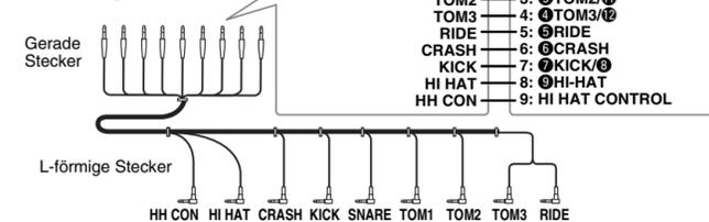
2. Stecken Sie die L-förmigen Stecker der neunkanaligen Kabelpeitsche in die entsprechenden Pads.
