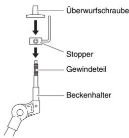
5. Ziehen Sie, während wie unten gezeigt der Stopper vollständigen Kontakt mit der Unterseite der Überwurfschraube hat, den Keilbolzen des Stoppers mit dem Stimmschlüssel fest.
