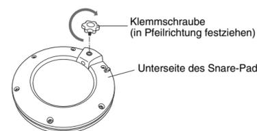
2. Schieben Sie das Snare-Pad auf die Snare-Halterung des Racks. Stellen Sie sicher, dass die Haltestange vollständig in die Montageöffnung des Snare-Pads eingeführt ist, und ziehen Sie dann die Klemmschraube fest, um die Pad-Position zu fixieren.
