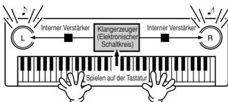
Je nach den Daten, die durch Spielen auf der Tastatur erzeugt werden, wird über die Lautsprecher eine im KLANGERZEUGER gespeicherte Sampling-Note wiedergegeben.
