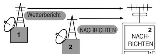
Eine MIDI-Übertragung funktioniert nach dem gleichen Grundprinzip. Das sendende Instrument sendet MIDI-Daten auf einem bestimmten MIDI-Kanal (MIDI-Sendekanal) über ein einfaches MIDI-Kabel an das empfangende Instrument. Wenn der MIDI-Kanal des empfangenden Instruments (MIDI Receive Channel) mit dem Sendekanal übereinstimmt, spielt das empfangende Instrument die Daten, die am sendenden Instrument abgesendet wurden.
