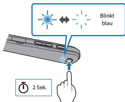
Stellt vorliegendes Gerät nicht automatisch eine Verbindung zu einem Bluetooth-Gerät her, wartet es auf eine Verbindung. Bedienen Sie das Bluetooth-Gerät, um eine Verbindung mit vorliegendem Gerät herzustellen.
