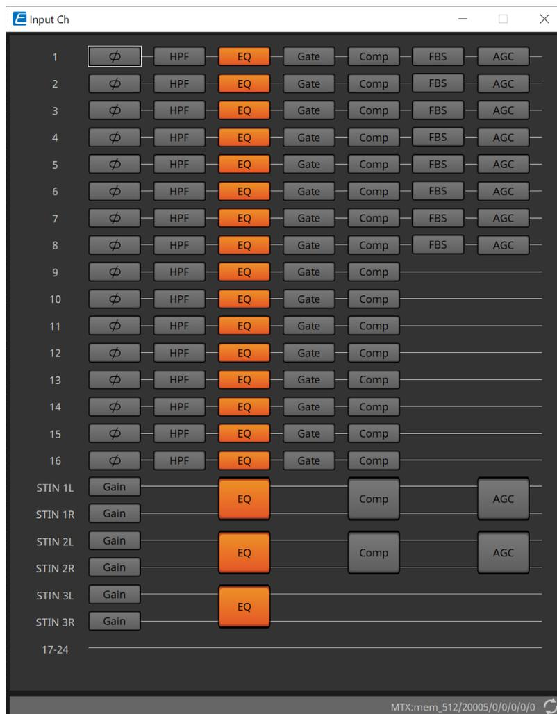
Viene eseguita l'elaborazione del segnale di polarità, "HPF", "EQ", "Gate", "Comp", "FBS" e "AGC".
