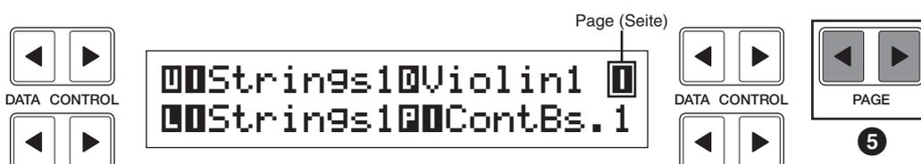
Mit Hilfe dieser Tasten **5** werden (falls verfügbar) die verschiedenen „Seiten“ (englisch: Page) des Displays ausgewählt. Die Nummern der Displayseiten werden oben rechts im LC-Display angezeigt. Mit [PAGE ] wählen Sie die nächste Page aus und mit [PAGE ] die vorhergehende Page.
