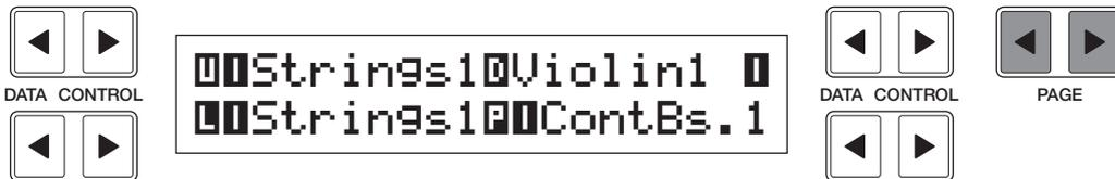
3. Gleichen Sie mit Hilfe der zugehörigen [DATA CONTROL]-Tasten oben rechts die Balance ab. Durch positive Werte wird die Lautstärke der Oberen Tastatur erhöht und durch negative Werte verringert bzw. die Lautstärke der Unteren Tastatur erhöht. Wertebereich: -6 - +6
