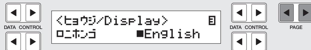
3. Durch Drücken eines der beiden [DATA CONTROL]-Tastenpaare wird die entsprechende Sprache ausgewählt: durch das rechte Paar Englisch und durch das linke Paar Japanisch.
