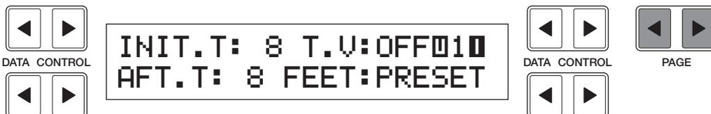
Mit Hilfe des [DATA CONTROL]-Tastenpaares oben links können Sie die Lautstärke der Voice ändern. Die Feineinstellung der Lautstärke kann in Stufen von 0-24 erfolgen.
