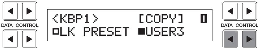
3. Wählen Sie durch Drücken der [DATA CONTROL]-Tasten die Funktion „Copy“ (Kopieren) aus.
