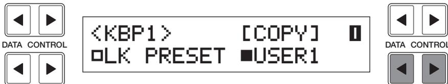
3. Wählen Sie durch Drücken der [DATA CONTROL]-Tasten oben rechts die Funktion „Copy“ (Kopieren) aus.
