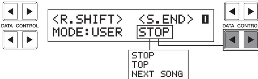
2. Wählen Sie mit Hilfe der [DATA CONTROL]-Tasten unten rechts die Shift End-Funktion aus. Die folgenden drei Typen stehen zur Verfügung:
