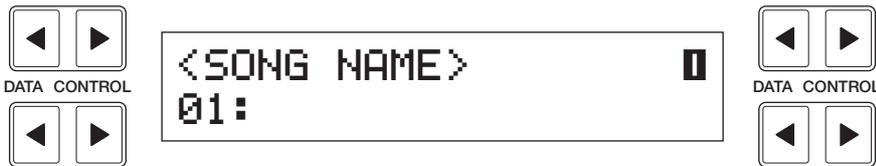
**4** Drücken Sie die [RECORD]-Taste. Die LED der [RECORD]-Taste und die LEDs der Tasten [PLAY] und [CUSTOM PLAY] blinken; dadurch wird gekennzeichnet, daß der Music Disk Recorder für die Aufnahme bereit ist.
