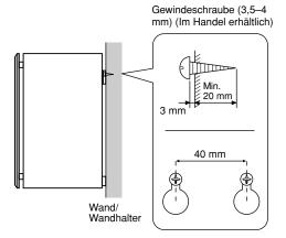
Sie können für das Montieren des Lautsprechers mit Hilfe einer im Handel erhältlichen Lautsprecher-Halterung auch die Schraubenlöcher auf der Rückseite des Lautsprechers verwenden (falls Sie nicht die beiliegende Montagehalterung verwenden).
