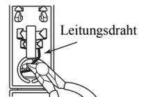
**4** Führen Sie den Kabeldraht in den Schlitz ein, und klemmen Sie diesen mit einer Zange fest.
