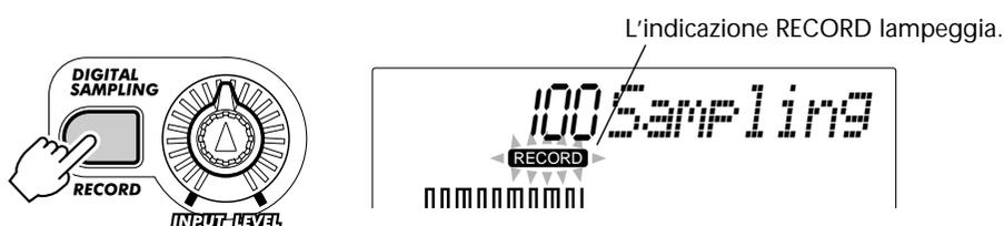
In questo modo si annulla qualsiasi altra operazione o funzione della DJX e si accede al modo Sampling. Viene disabilitato il dial MASTER VOLUME: il livello del suono è controllato solo dalla manopola INPUT LEVEL.
