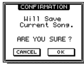
4. Usate i tasti CURSOR [◀]/[▶]/[▲]/[▼] nella parte centrale destra del pannello superiore per spostare il cursore (il rettangolo lampeggiante) sul pulsante OK, e premete il tasto [ENTER] situato immediatamente al di sotto.
