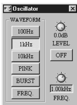
Oltre alla possibilità di variare il controllo **FREQ** agendo sulla sua icona, le frequenze possono essere specificate usando la tastiera del computer. È sufficiente selezionare il valore sotto il controllo **FREQ** usando il mouse, immettere un valore via tastiera e quindi premere il tasto **ENTER**. Il valore appena immesso viene inserito ed il controllo **FREQ** si sposta sulla nuova posizione.
