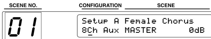
Normalmente vengono visualizzati solo i primi sette caratteri del titolo di un componente. Premendo il pulsante [COMPONENT] viene mostrato l'intero titolo, con l'impiego della sezione PARAMETER del display. Ripremete il pulsante per ritornare alla visualizzazione normale (quella ridotta).
