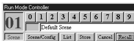
Il DME32 si commuta sul modo Run e mostra il titolo della configurazione, il titolo della scena e il valore del parametro del componente selezionato. Questo è il primo parametro del primo componente, a meno che il pulsante [USER DEFINE] abbia avuto un'assegnazione diversa, nel qual caso il parametro assegnato a quel pulsante viene selezionato e si accende la spia USER DEFINE. È la stessa cosa che accade quando si accende il DME32 senza aver collegato il DME Manager.
