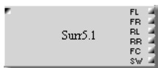
Il componente 5+1 ha un ingresso e sei uscite: FL (front-left o anteriore sinistra), FC (front-center o frontale/centrale), FR (front-right o anteriore destra), RL (rear-left o posteriore sinistra), RR (rear-right o posteriore destra) e SW (subwoofer).
