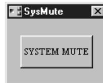
Quando si clicca sul pulsante SYSTEM MUTE, tutte le uscite dell'intero sistema DME32, comprese le uscite di tutti i DME32 costituenti un sistema multi-unità, vengono escluse. Ricliccando sullo stesso pulsante, tutte le uscite vengono riattivate.
