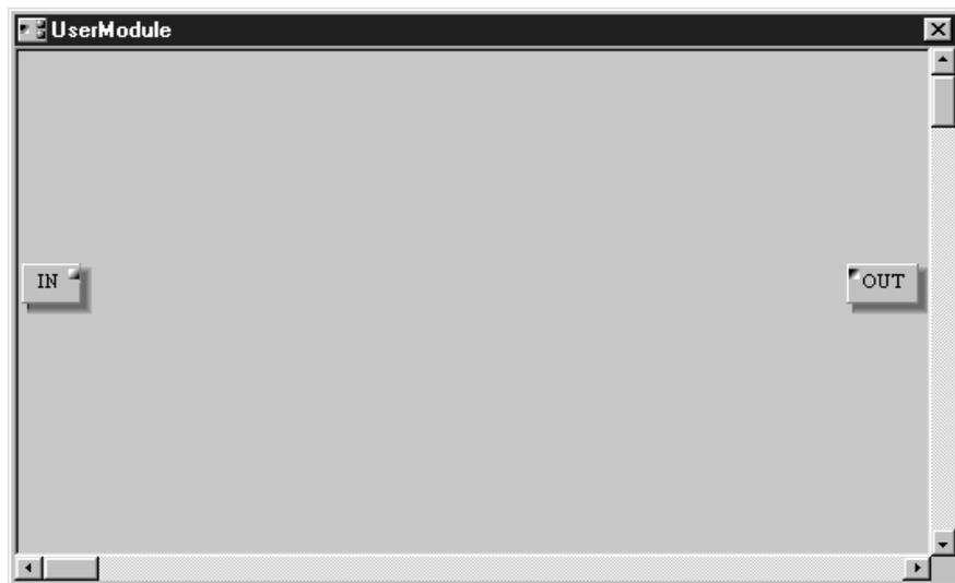
Inizialmente la finestra User Module ha un solo ingresso ed una sola uscita. Mediante la finestra Properties, possono diventare 16 e 16. Vedere a pagina 80 ulteriori informazioni sulla personalizzazione delle proprietà dei componenti.
