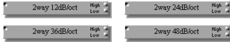
Ogni componente 2-way Crossover comprende un ingresso e due uscite: High e Low. Poiché l'unica differenza fra tutti i componenti 2-way Crossover dipende dalla pendenza del filtro, qui riporteremo soltanto la finestra di controllo 2-Way 12 dB/octave. Ogni finestra di controllo 2-way Crossover dispone di un grafico crossover e delle sezioni INPUT, LOW e HIGH.
