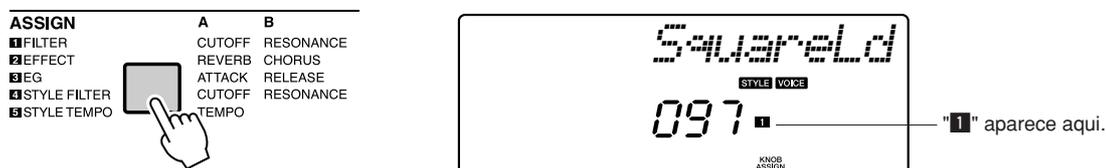
Agora, o Botão de Controle A pode ser utilizado para ajustar a frequência de corte do filtro, enquanto o Botão de Controle B pode ser utilizado para ajustar a ressonância.
