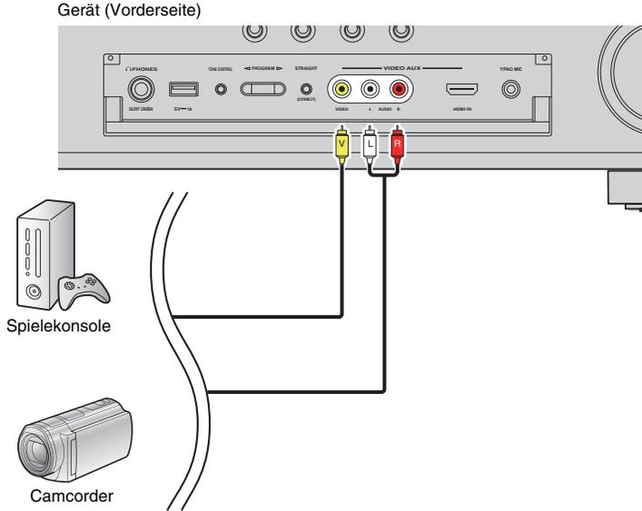
Wenn Sie die Eingangsquelle „V-AUX“ durch Drücken von V-AUX auswählen, werden die am Videogerät abgespielten Video-/Audiosignale am Gerät ausgegeben.
