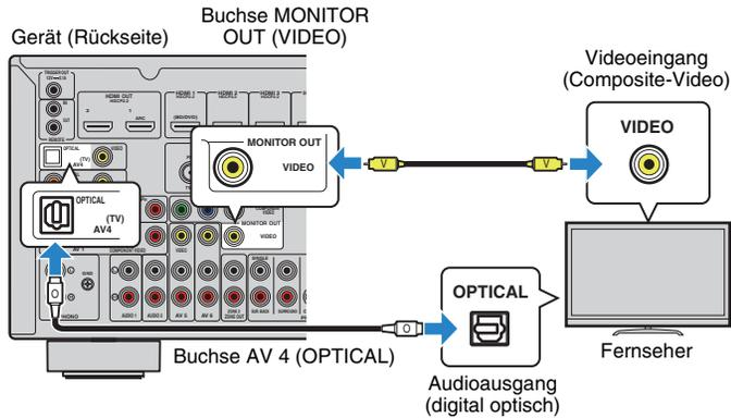
■ Anschließen eines weiteren Fernsehgeräts oder eines Projektors
