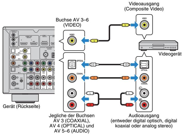
Wenn Sie die Eingangsquelle durch Drücken von AV 3-6 auswählen, werden die am Videogerät abgespielten Video-/Audiosignale vom Gerät ausgegeben.
