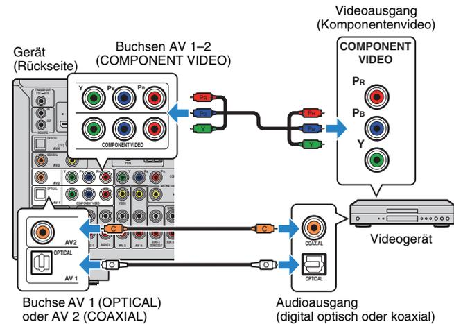
Wenn Sie die Eingangsquelle durch Drücken von AV 1-2 auswählen, werden die am Videogerät abgespielten Video-/Audiosignale vom Gerät ausgegeben.
