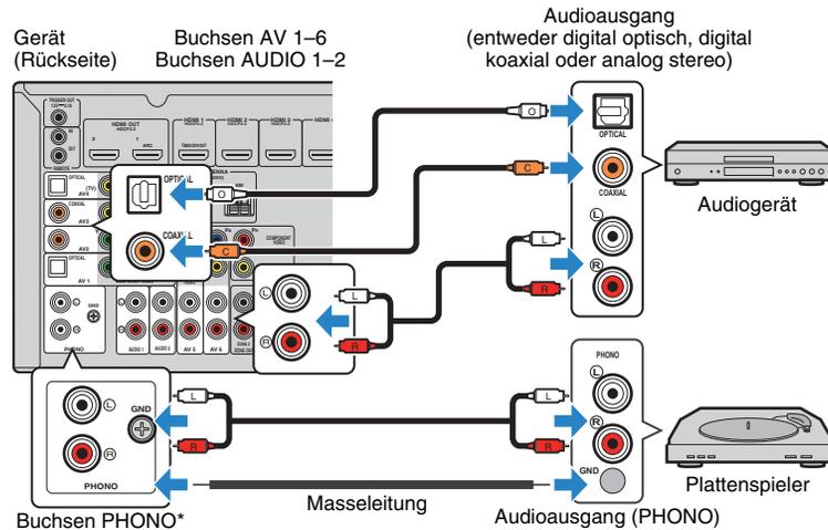
Wenn Sie die Eingangsquelle durch Drücken von AV 1-6, AUDIO oder PHONO\* auswählen, werden die am Audiogerät abgespielten Audiosignale am Gerät ausgegeben.
