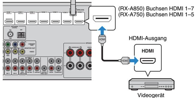
Wenn Sie die Eingangsquelle durch Drücken von HDMI 1-7 (RX-A850) oder HDMI 1-5 (RX-A750) auswählen, werden die am Videogerät abgespielten Video-/Audiosignale vom Gerät ausgegeben.
