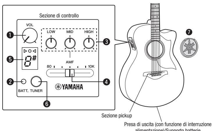
Presa di uscita (con funzione di interruzione alimentazione)/Supporto batterie
