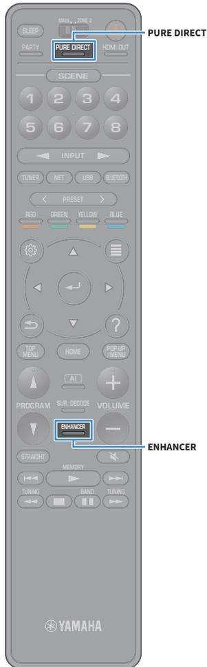
Wurde Pure Direct aktiviert, gibt das Gerät die ausgewählte Signalquelle auf dem direktesten Signalweg wieder, um Rauschen und elektrische Geräusche von anderen Schaltungen (wie dem Frontblende-Display) zu reduzieren. Dadurch erleben Sie die reine Hi-Fi-Klangqualität.
