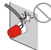
Wird „Check SP Wires“ (LS-Kabel prüfen) im Frontblende-Display angezeigt, wenn das Gerät eingeschaltet wird, schalten Sie das Gerät aus und untersuchen Sie dann die Lautsprecherkabel auf Kurzschluss.
