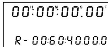
Der angezeigte Remaining-Wert bezieht sich auf die Restaufnahmedauer für alle derzeit aktivierten Spuren. Wenn Sie also z.B. vier Spuren mit den betreffenden [RECORD READY]-Tasten aufnahmebereit machen und dann die [REMAIN]-Taste betätigen, wird die für diese vier Spuren (nachstehend beispielsweise 1~4) verbleibende Aufnahmedauer angezeigt.
