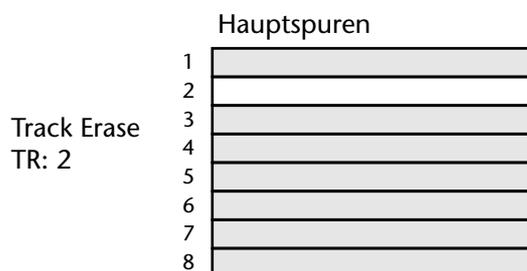
Die Daten einer "entleerten" Spur können zwar nicht mehr verwendet werden, sind aber nach wie vor auf dem Datenträger vorhanden und nehmen Platz weg, den Sie für Neuaufnahmen verwenden könnten. Am besten entfernen Sie alle überflüssigen Daten mit der Optimize-Funktion. Alles Weitere hierzu erfahren Sie unter "Optimize: 'Aufräumen' des Datenträgers" auf Seite 178.
