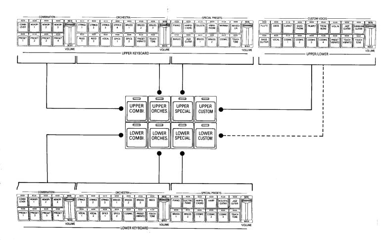
Wie aus der Abbildung oben hervorgeht, entspricht die obere Tastenreihe des Ensemble-Abschnitts den Registern des oberen Manuals, die untere Reihe den Registern des unteren Manuals. Für das obere und untere Manual lassen sich bis zu jeweils vier verschiedene Registergruppen kombinieren. Außerdem können Sie wählen, ob die CUSTOM VOICES (Solostimmen) auf dem oberen oder unteren Manual erklingen sollen.
