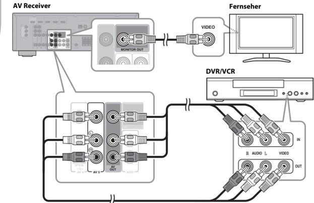
Schließen Sie die MONITOR OUT-Buchse des AV Receiver über ein optionales Videokabel wie abgebildet am Composite-Eingang Ihres Fernsehers an.
