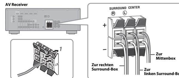
Schließen Sie die Kabel des Center-Lautsprechers (H) und der Surround-Lautsprecher (G) am AV Receiver an. Vergewissern Sie sich, dass Sie die Boxen mit richtiger Polarität anschließen – Positive (+) Klemmen an positive (+) Klemmen und negative (-) Klemmen an (-) Klemmen.
