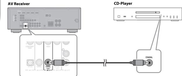
Verwenden Sie ein koaxiales Digitalkabel (nicht mitgeliefert), um Ihren CD-Player wie abgebildet mit der Buchse AV 3 COAXIAL(CD) des AV Receiver zu verbinden.
