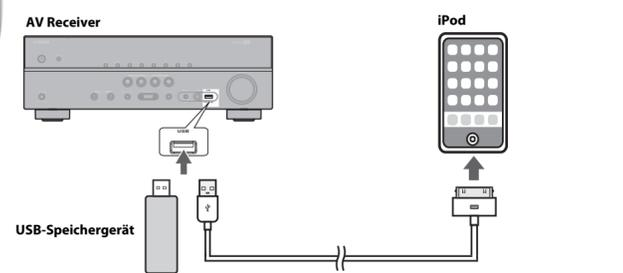
Verbinden Sie ein USB-Speichergerät oder das mit dem iPod gelieferte USB-Kabel wie abgebildet mit der USB-Buchse am AV Receiver (an der Frontblende).
