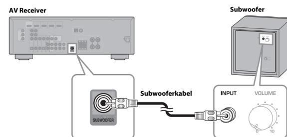
Verbinden Sie die INPUT-Buchse des Subwoofers mit Hilfe des beiliegenden Subwooferkabels (J) mit der Buchse SUBWOOFER am AV Receiver.
