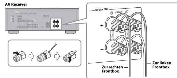
Schließen Sie die Kabel der Front-Lautsprecher (G) am AV Receiver an. Vergewissern Sie sich, dass Sie die Boxen mit richtiger Polarität anschließen – Positive (+) Klemmen an positive (+) Klemmen und negative (-) Klemmen an (-) Klemmen.
