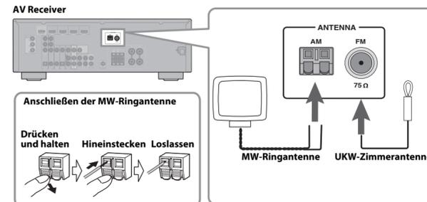
Schließen Sie die MW-Ringantenne (D) und die UKW-Zimmerantenne (E) wie abgebildet am AV Receiver an. Genauere Hinweise zum Anschließen der Antennen finden Sie in den betreffenden Bedienungsanleitungen.
