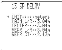
**Gamma controllo:** da 0,15 a 30,48 m (canali principali destro e sinistro, centrale, posteriori destro e sinistro, centrale posteriore)
