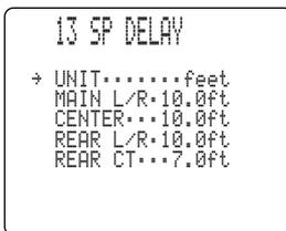
**Gamma controllo:** da 0,5 a 100 ft (canali principali destro e sinistro, centrale, posteriori destro e sinistro, centrale posteriore)
