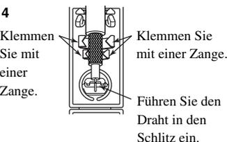
Führen Sie den Kabeldraht in den Schlitz ein, und klemmen Sie ihn mit einer Zange fest.
