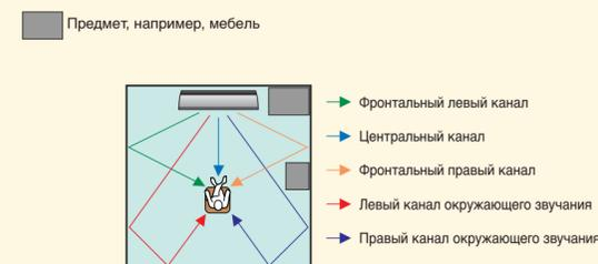
Установите данный аппарат в углу с углом 40° - 50° от смежных стен.
