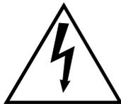
Il lampo con la freccia all'interno di un triangolo equilatero avverte l'utente della presenza di "voltage pericoloso" all'interno del prodotto, sufficiente per rappresentare un rischio di shock elettrico.
