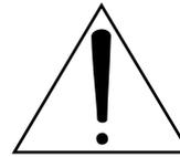
Il punto esclamativo all'interno di un triangolo equilatero serve a segnalare all'utente l'esistenza di importanti istruzioni operative e di manutenzione nella documentazione che corredata lo strumento.
