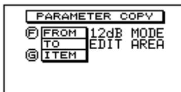
FROM/TO: Wählen Sie zum Linearisieren der EQ-Einstellungen mit Drehgeber (F) zwischen den zwei Initialisierungsmodi für den grafischen 30-Band-Equalizer: entweder "12dB MODE" (mit einer Intensität von  $\pm 12$  dB) oder "6dB MODE" (mit einer Intensität von  $\pm 6$  dB). Das gewählte "Modell" wird in den Arbeitsspeicher (EDIT AREA) kopiert.
