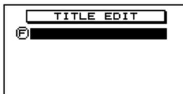
Wählen Sie die einzugebenden Zeichen (0-9, A-Z, a-z und Satzzeichen) mit dem Drehgeber **Ⓕ**, und benützen Sie die Tasten **L/◀** und **R/▶** als Cursor. Mit der Taste **STORE** kann bequem eine Leerstelle eingegeben werden.
