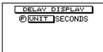
UNIT ist der einzige regelbare Parameter dieser Funktion. Für Anwendungen im PA-Bereich ist der Delay-Effekt, d. h. die Verzögerung eines oder beider Stereokanäle oft unabdinglich, beispielsweise um Phasenverschiebungen zwischen verschiedenartig aufgestellten Lautsprechern auszugleichen.
