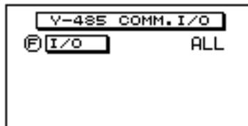
I/O ist der einzige regelbare Parameter dieser Funktion. Wählen Sie mit Drehgeber (F), welche Ein- und Ausgangsdaten bei Übertragungen im Y-485-Format berücksichtigt werden sollen: OFF (keine), PGM CHANGE (nur Programm-Change-Befehle) und ALL (alle Daten).
