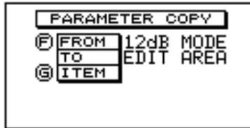
1. Drücken Sie die Taste **UTILITY** so oft, bis das PARAMETER-COPY-Fenster angezeigt wird.
