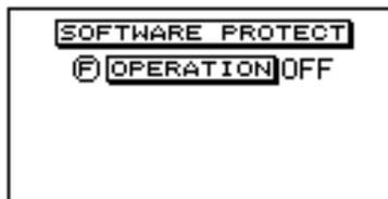
OPERATION ist der einzige regelbare Parameter dieser Funktion. Stellen Sie mit Drehgeber (F) die Datenschutzfunktion ein (ON) oder aus (OFF). Bei eingeschalteter Datenschutzfunktion werden MIDI- oder Y-485-Programmwechselbefehle ignoriert. Beim Versuch, Einstellungen zu kopieren, speichern oder editieren, wird die Meldung "ERR \*\* NOW PROTECT" (Fehler – Datenschutz) auf dem Display angezeigt.
