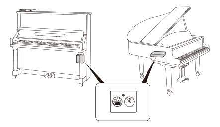
Mounting the Control Unit to the Grand Piano Montaje de la Unidad de control en el Gran Piano Установка блока управления на Disklavier модели «рояль» 将控制器安装在大钢琴上 將控制器安裝在大鋼琴上 그랜드피아노에 컨트롤 유닛 장착하기
