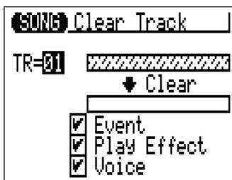
Mit dem Parameter „**TR**“ legen Sie den/die zu löschenden Track(s) fest: „01“ bis „16“ für die Sequencertracks, „Pt“ oder „Cd“ für die Begleittracks, „Tm“ für den Tempotrack oder „Al“ für alle Tracks.
