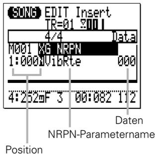
\* Wenn ein Drum Setup-Parameter ausgewählt ist, um eine Drum anzugeben, wird „Note“ angezeigt.
