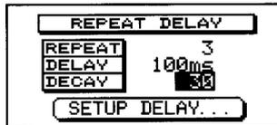
★ Sie können die Zeiten und Pegel aller Taps durch Drücken der Taste [DELAY] anzeigen lassen.
