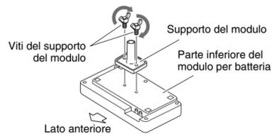
2. Inserire il supporto del modulo nel morsetto di sostegno, quindi serrare il morsetto di chiusura per fissarlo in posizione.
