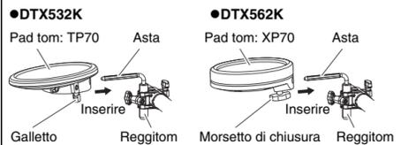
3. Allentare i morsetti di chiusura da A a C, come illustrato di seguito, per regolare l'altezza e l'angolazione della superficie di utilizzo di ciascun pad tom. Una volta effettuato il corretto posizionamento, accertarsi di serrare di nuovo i morsetti di chiusura in modo appropriato prima di procedere con l'operazione successiva.
