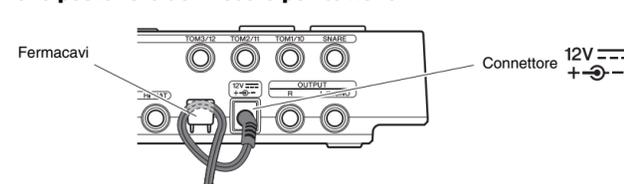
2. Utilizzando le fasce, fissare i cavi nel rack del kit nelle posizioni indicate dal cerchio nella figura a destra.
