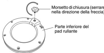
2. Inserire il pad rullante sul reggirullante del rack. Assicurarsi che l'asta del reggirullante sia completamente inserita nel foro di montaggio del pad rullante, quindi serrare il morsetto di chiusura per fissare il pad.
