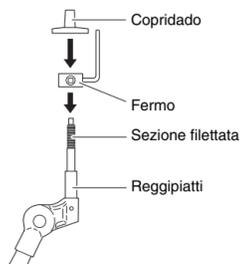
5. Quando il fermo è completamente a contatto con la superficie inferiore del copridado, come illustrato di seguito, stringere la vite del fermo utilizzando la chiave di accordatura.
