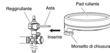
3. Allentare i morsetti di chiusura da A a D, come illustrato di seguito, per regolare l'altezza e l'angolazione della superficie di utilizzo del pad rullante. Una volta effettuato il corretto posizionamento, accertarsi di serrare di nuovo i morsetti di chiusura in modo appropriato prima di procedere con l'operazione successiva.
