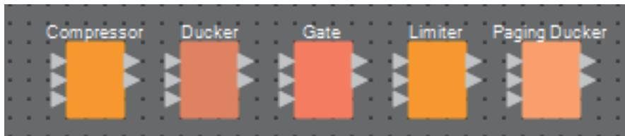
Bei allen Komponenten außer dem Paging Ducker dient der untere Eingang zur Eingabe des Key-In-Signals. Beim Paging Ducker dient der untere Eingang zur Eingabe des Signals vom Durchsagemikrofon.
