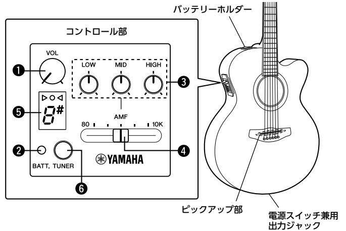
ギター本体に内蔵されたプリアンプは、出力ジャックにプラグを差し込むと電源が ON となります。
