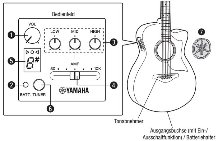
Der eingebaute Vorverstärker wird automatisch eingeschaltet, wenn Sie ein Kabel an die Ausgangsbuchse anschließen. Stellen Sie die Lautstärke stets auf Minimum, bevor Sie das Kabel anschließen oder abziehen.
