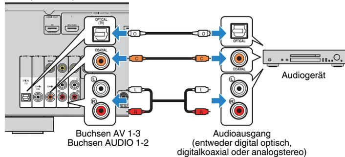
Wenn Sie AV 1-3 oder AUDIO 1-2 durch Drücken von INPUT als Eingangsquelle auswählen, werden die am Audiogerät abgespielten Audiosignale vom Gerät ausgegeben.
