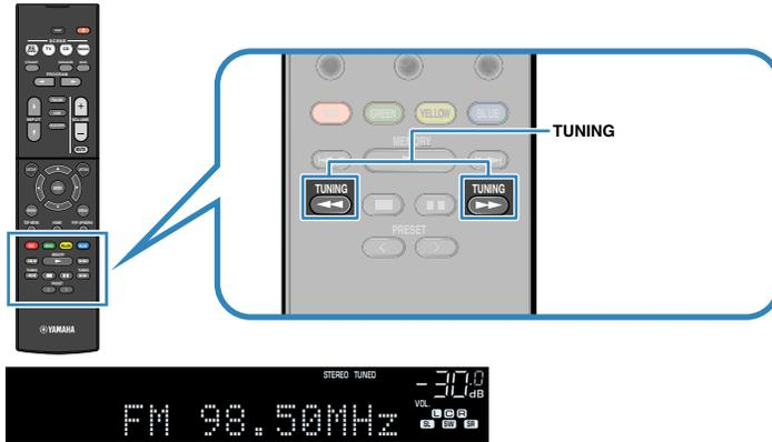
„TUNED“ leuchtet, wenn das Signal eines FM-/AM-Senders empfangen wird.
