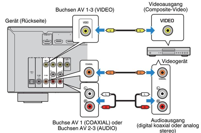
Wenn Sie AV 1-3 durch Drücken von INPUT als Eingangsquelle auswählen, werden die am Videogerät abgespielten Video-/Audiosignale vom Gerät ausgegeben.
