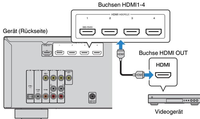
Wenn Sie HDMI 1-4 durch Drücken von INPUT als Eingangsquelle auswählen, werden die am Videogerät abgespielten Video-/Audiosignale vom Gerät ausgegeben.
