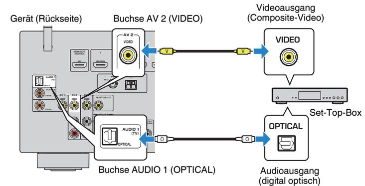
**1** Drücken Sie INPUT zur Auswahl von „AV 2“ (zu verwendende Video-Eingangsbuchse) als Eingangsquelle.
