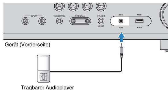
Wenn Sie „AUX“ als Eingangsquelle durch Drücken von INPUT auswählen, werden die am Gerät abgespielten Audiosignale vom Gerät ausgegeben.
