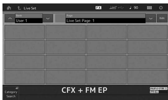
**3 Tippen Sie auf einen der Slots. Die aktuell ausgewählte Performance wird im Slot registriert (gespeichert).**
