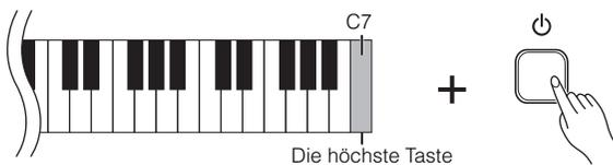
Falls dieses Instrument eine Betriebsstörung oder Fehlfunktion hat, schalten Sie das Instrument aus, und führen Sie dann das Initialisierungsverfahren durch.
