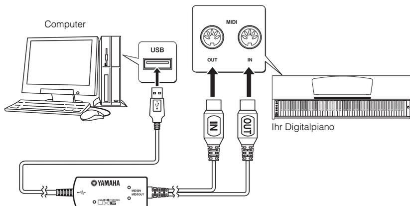
Schalten Sie zunächst sowohl dieses Instrument als auch den Computer aus, bevor Sie die Verbindung zwischen den beiden Geräten herstellen. Nachdem Sie die Verbindung hergestellt haben, schalten Sie zuerst den Computer ein und dann dieses Instrument.
