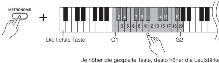
Um das Tempo bei gestopptem Metronom auf den Standardwert 120 zurückzusetzen, drücken Sie gleichzeitig die Tasten [METRONOME], [+ R] und [- L].
