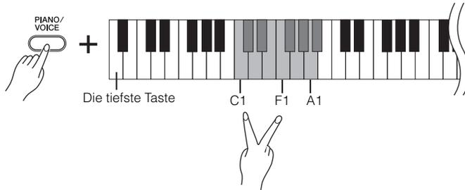
Die der tieferen Taste zugewiesene Voice wird als Voice 1 bezeichnet, die der höheren Taste zugewiesene als Voice 2.
