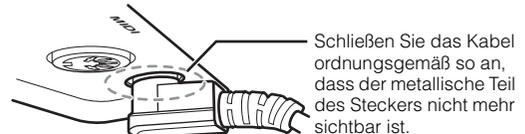
Schließen Sie das Kabel ordnungsgemäß so an, dass der metallische Teil des Steckers nicht mehr sichtbar ist.
