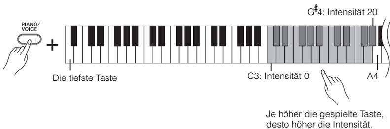
Halten Sie die Taste [PIANO/VOICE] gedrückt, und schlagen Sie die Taste A4 an, um den Halleffekt auf die am besten geeignete Intensität für die ausgewählte Voice einzustellen.
