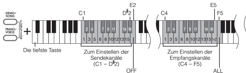
Im Dual-Modus werden die Daten von Voice 1 auf dem dieser Voice zugeordneten Kanal und die Daten von Voice 2 auf der nächsthöheren Kanalnummer im Vergleich zum angegebenen Kanal gesendet. In diesem Modus werden keine Daten übertragen, wenn der Übertragungskanal auf „OFF“ gesetzt ist.
