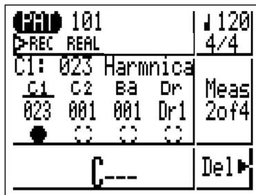
Um Fehler zu löschen, spielen Sie einfach die zu löschende Note auf der Mikrotastatur, während Sie die Funktionstaste neben dem Eintrag "del" in der Anzeige gedrückt halten. Alle entsprechenden Noten, die gespielt werden, während die Taste auf der Mikrotastatur gehalten ist, werden gelöscht.
