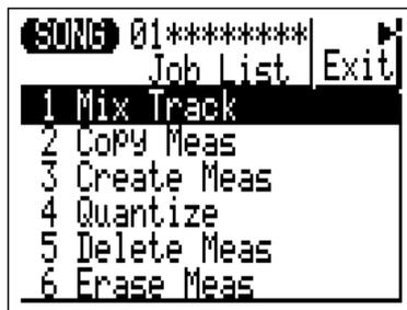
Die Menü-Taste [MENU] ruft ein Menü von Funktionen oder Unterebenen auf, die in dem gerade gewählten Modus des QY22 verfügbar sind; die Funktionstasten (die kleinen runden gelben Tasten) wählen den nebenstehenden Eintrag in der Anzeige.
