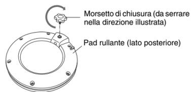
2. Montaggio del pad rullante sull'asta del morsetto del rack. Assicurarsi che l'elemento dell'asta sia completamente inserito nel foro di montaggio del pad, quindi serrare completamente il morsetto di chiusura, come illustrato di seguito.
