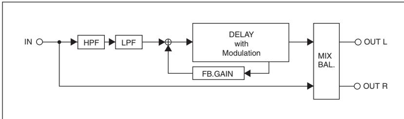
Diese Delay-Effekte erlauben das Modulieren der Wiederholungen.
