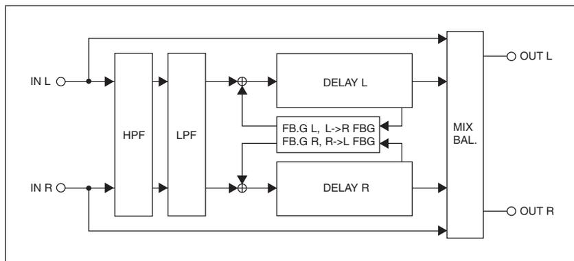
Diese Effekte fügen zwei Wiederholungslinien hinzu: Eine für den linken (L) und eine für den rechten (R) Kanal. Das erinnert zwar an den Stereo Delay-Effekt (Seite 40), jedoch mischt die Rückkopplungsschleife von Echo die L- und R-Verzögerung. Der Pegel des vom L- zum R-Kanal und vom R- zum L-Kanal übertragenen Signals ist einstellbar.
