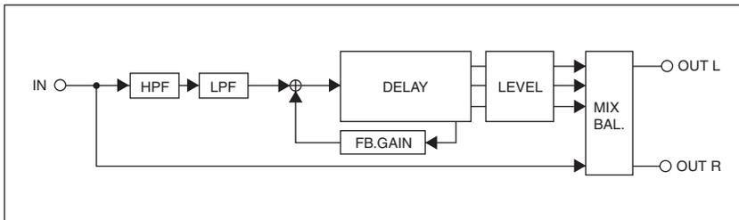
Dieser Effekt bietet drei Wiederholungslinien: Links, Mitte und rechts. Diese Linien können separat eingestellt werden. Hier stehen folgende Parameter zur Verfügung:
