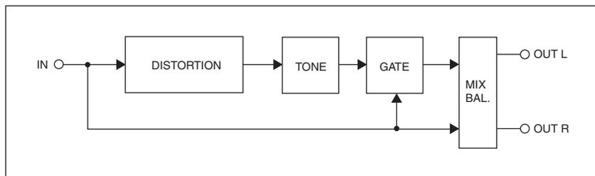
Dieser Effekt erzeugt Verzerrung, die sich vor allem für elektrische Gitarren eignet. Hier stehen folgende Parameter zur Verfügung:
