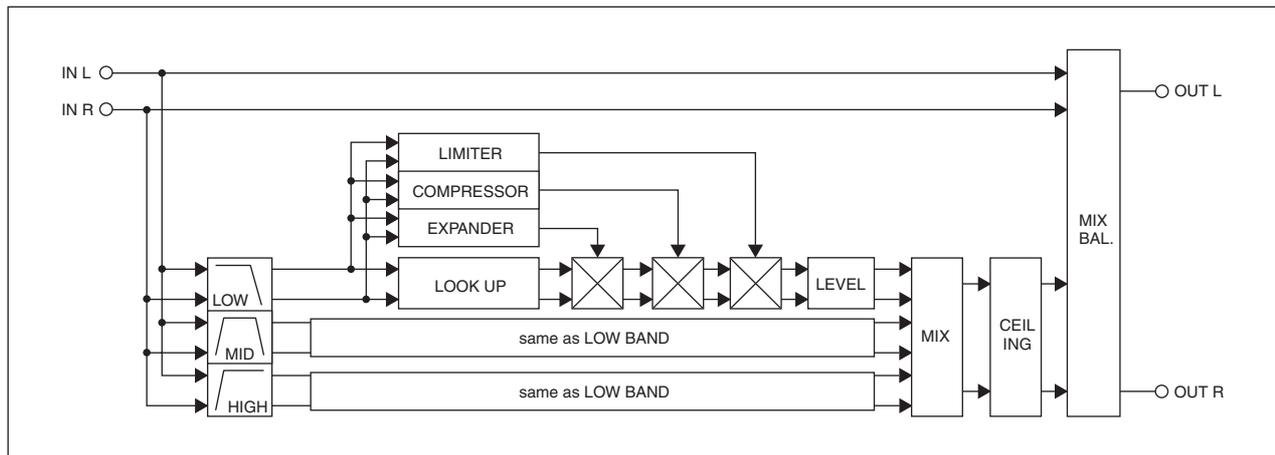
Mit diesem Effekt kann die Dynamik der eingehenden Signale bearbeitet werden. Bei Bedarf können drei Dynamikprozessoren – auch kombiniert – verwendet werden: Kompressor, Expander und Limiter. Die Reihenfolge lautet: Expander, Kompressor, Limiter.
