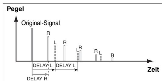
Dieser Effekt bietet zwei Wiederholungslinien: Eine für den linken (L) und eine für den rechten (R) Kanal. Diese beiden Linien können separat eingestellt werden.
