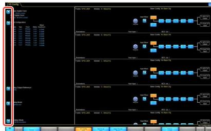
**6. Schalten Sie zwischen den Tasten [Host Out Ch] und [AES CH] um und wählen Sie so die Eingangsquelle des Moduls.**
