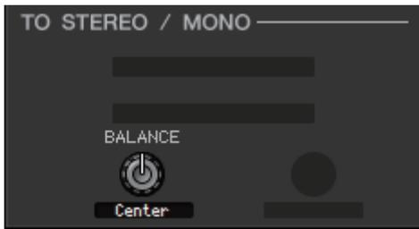
Diese regelt das Links/Rechts-Lautstärkeverhältnis im STEREO-Bus. Sie können hier den Mittenwert einstellen, indem Sie die <Strg><⌘>-Taste auf der Computertastatur gedrückt halten und auf diesen Drehregler klicken.
