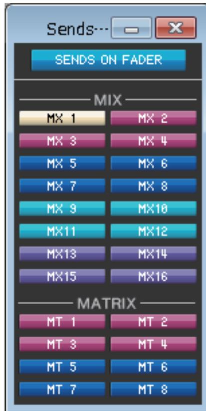
Im Modus SENDS ON FADER können Sie den Send-Pegel zum MIX-/MATRIX-Bus mit dem Fader einstellen. In diesem Modus werden die von allen Eingangskanälen an einen bestimmten MIX-/MATRIX-Bus gesendeten Signale gleichzeitig eingestellt.
