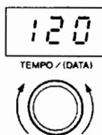
Quando viene ruotato verso sinistra, il valore visualizzato ed il tempo diminuiscono gradualmente (minimo 40).
