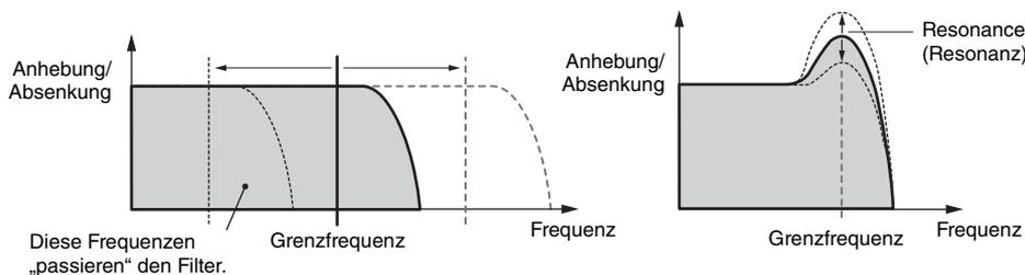
**LPF24D:** Ein dynamischer Tiefpassfilter mit -24 dB/Oktave und einem charakteristischen Digitalsound. Verglichen mit dem Typ LPF24A kann dieser Filter einen ausgeprägteren Resonanzeffekt erzeugen.
