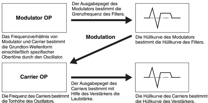
Die oben beschriebene Abbildung beschreibt Waveforms, die aus zwei Operatoren erzeugt werden, der MODX+ besitzt jedoch acht Operatoren. Die Kombination einer Anzahl von Operatoren wird „Algorithm“ genannt. Dieser Synthesizer besitzt Parameter zum Einstellen der Algorithmen.
