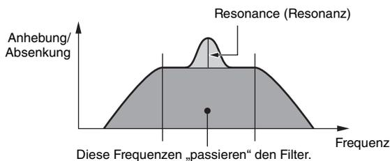
**BPFw:** Ein BPF mit  $-12$  dB/Oktave, das HPF- und LPF-Filter so kombiniert, dass breitere Bandbreiteneinstellungen möglich sind.
