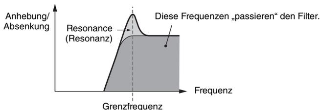
**LPF12+HPF12:** Eine serielle Kombination aus einem Tiefpassfilter und einem Hochpassfilter mit jeweils  $-12$  dB/Oktave. Wenn dieser Filtertyp ausgewählt ist, können HPF Cutoff und HPF Key Follow Sensitivity eingestellt werden.
