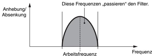
**BPF12D:** Kombination eines HPF und eines LPF mit  $-12$  dB/Oktave und einem charakteristischen Digitalsound.
