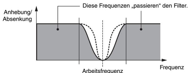
**BEF12:** Bandsperrfilter mit  $-12$  dB/Okt.**BEF6:** Bandsperrfilter mit  $-6$  dB/Okt.**DualLPF:** Zwei parallel geschaltete Tiefpassfilter mit  $-12$  dB/Oktave. Sie können den Abstand zwischen den beiden Grenzfrequenzen einstellen.
