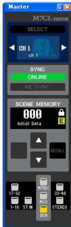
Im Master-Fenster können Sie zum M7CL synchronisieren, Szenen laden und das Overview-Fenster (Übersichtsfenster) anzeigen. Wählen Sie [Master] aus dem [Windows]-Menü (Fenster-Menü), um dieses Fenster zu öffnen.
