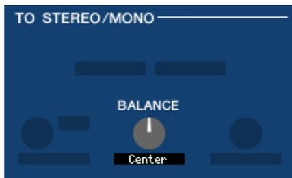
Diese Funktion wird nur angezeigt, wenn der ausgewählte MATRIX-Bus in Stereo verwendet wird. Sie regelt das Links/Rechts-Lautstärkeverhältnis der Stereosignals. Sie können hier den Mittenwert einstellen, indem Sie die <Strg>-Taste der Computertastatur gedrückt halten und auf diesen Regler klicken.
