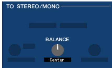
Diese Funktion regelt das Links/Rechts-Lautstärkeverhältnis im STEREO-Bus. Sie können hier den Mittenwert einstellen, indem Sie die <Strg>-Taste der Computertastatur gedrückt halten und auf diesen Regler klicken.
