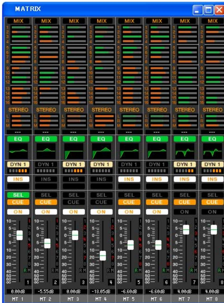
In diesem Fenster können Sie die Parameter der MATRIX-Kanäle 1–8 betrachten und bearbeiten. Die im Fenster angezeigten Parameter können im [View]-Menü (Ansicht) oder in dem Menü ausgewählt werden, das erscheint, wenn Sie mit der rechten Maustaste in das Fenster klicken.
