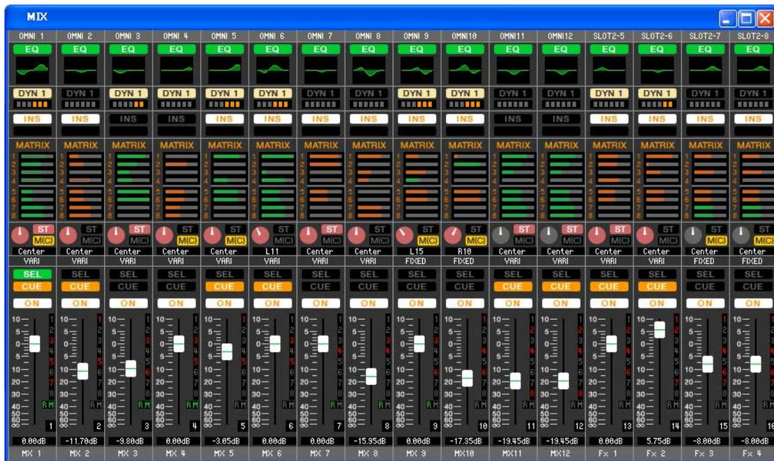
In diesem Fenster können Sie die Parameter der MIX-Kanäle 1–16 betrachten und bearbeiten. Die im Fenster angezeigten Parameter können im [View]-Menü (Ansicht) oder in dem Menü ausgewählt werden, das erscheint, wenn Sie mit der rechten Maustaste in das Fenster klicken.
