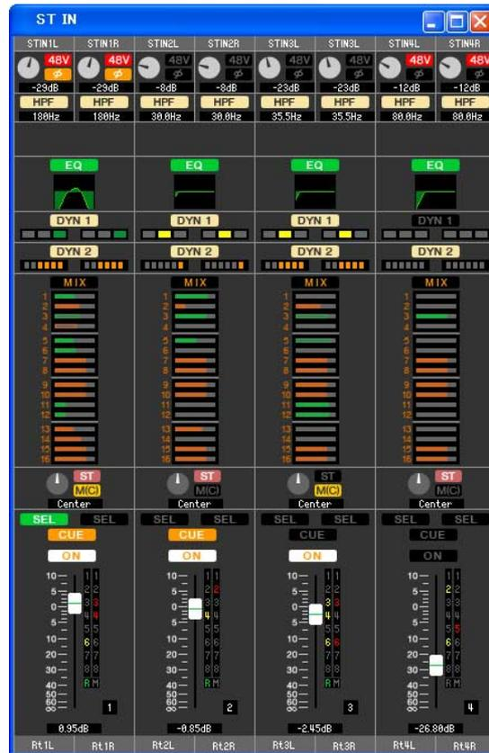
In diesem Fenster können Sie die Mix-Parameter der ST-IN-Kanäle 1–4 betrachten und bearbeiten. Die im Fenster angezeigten Parameter können im [View]-Menü (Ansicht) oder in dem Menü ausgewählt werden, das erscheint, wenn Sie mit der rechten Maustaste in das Fenster klicken.
