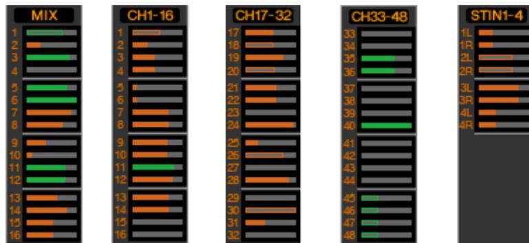
Die Balken unmittelbar unterhalb der Schaltfläche zeigen/regulieren den Pegel der Signale, die von ein einzelnen Kanälen an den MATRIX-Bus gesendet werden. Die Art der Bedienung und die Bedeutung der Anzeigen sind die gleichen wie bei (⑤) MATRIX im MIX-Fenster (➔ S. 17).
