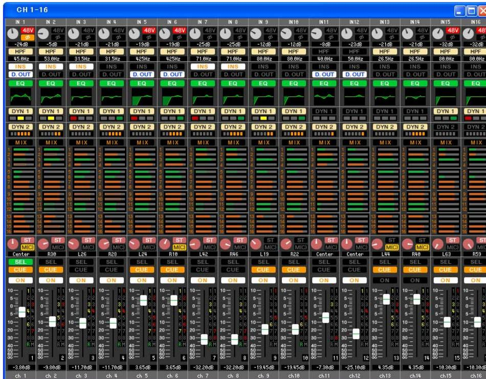
Dieses Fenster zeigt die Mix-Parameter von INPUT CH 1–16, 17–32 oder 33–48(\*) an. Die im Fenster angezeigten Parameter können im [View]-Menü (Ansicht) oder in dem Menü ausgewählt werden, das erscheint, wenn Sie mit der rechten Maustaste in das Fenster klicken.
