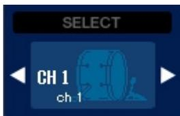
Hier werden Nummer und Name des Kanals angezeigt, auf den Ihre Bedienvorgänge angewendet werden. Um den Kanal zu wechseln, können Sie entweder auf die Schaltfläche [SELECT] (Auswahl) klicken und aus der daraufhin erscheinenden Liste einen Kanal auswählen, oder Sie können auf die Kanalauswahlschaltflächen in Form von Links-/Rechtspfeilen klicken. Sie können auch das Kanalnamen-Textfeld verwenden, um den Namen zu bearbeiten.
